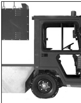
Das Diesel-Aggregat wird einfach abgeschraubt und weggehievt.
