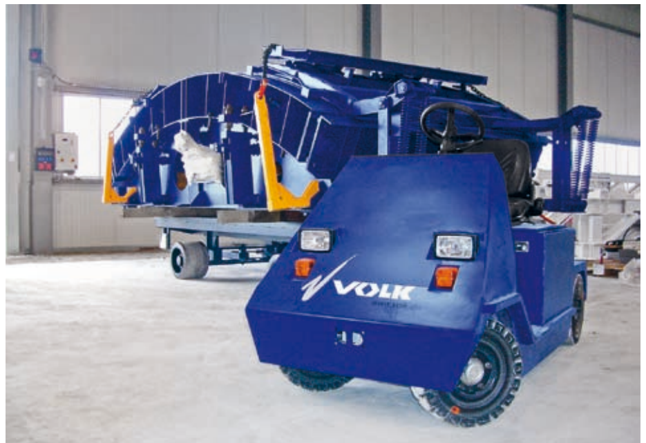
□ Ein Elektroschlepper EFZ 20 K mit einer Tübbing-Schalung im Schlepptau
